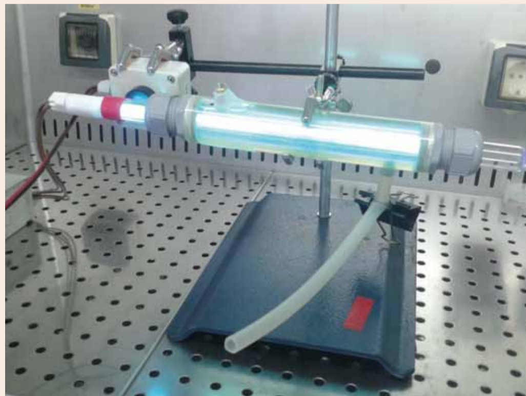
FIGURA 1 - PROTOTIPO STATICO IN CAPPA STERILE PER PROVE MICROBIOLOGICHE
